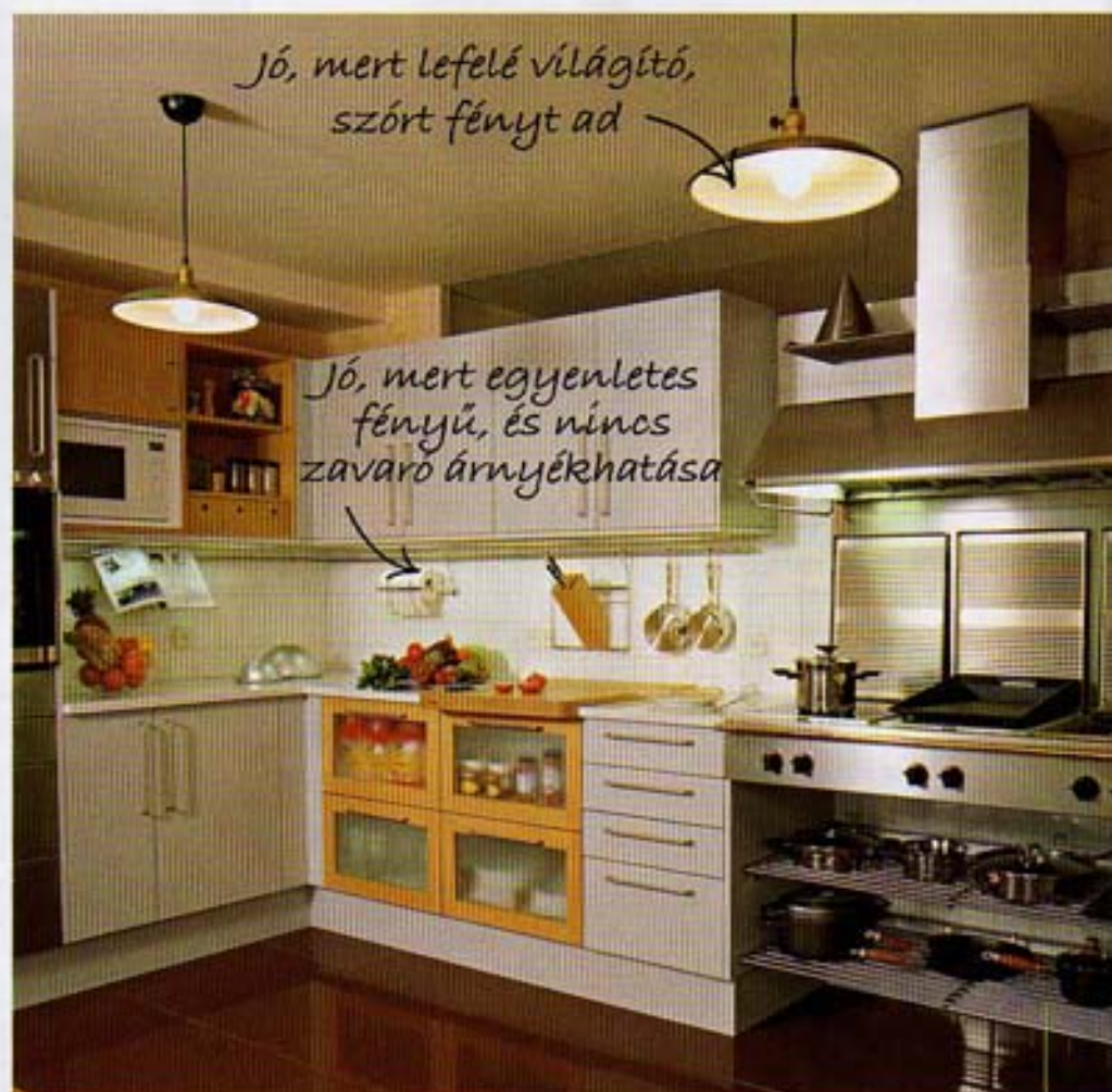
A konyhában helyi megvilágításnak válasszunk korszerű fénycsöveket, melyeket a felső szekrény belső szélére szereljük fel. Szükség van ugyanitt függesztett lámpákkal megoldott általános világításra is
