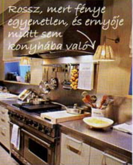
A konyhában helyi megvilágításnak válasszunk korszerű fénycsöveket, melyeket a felső szekrény belső szélére szereljük fel. Szükség van ugyanitt függesztett lámpákkal megoldott általános világításra is
