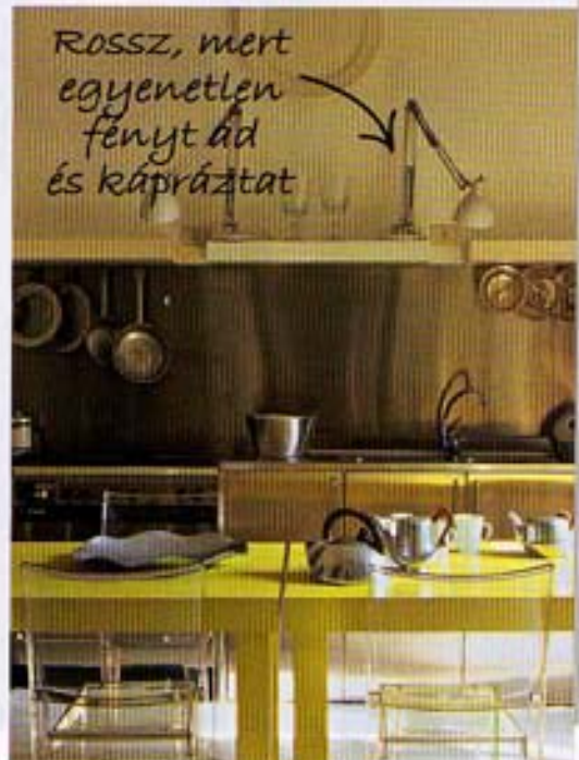
Íróasztali lámpákkal nem lehet a pultot jól megvilágítani. Több, különböző irányból érkező, pontszerű fényforrás zavaró árnyékhatást is kelt
